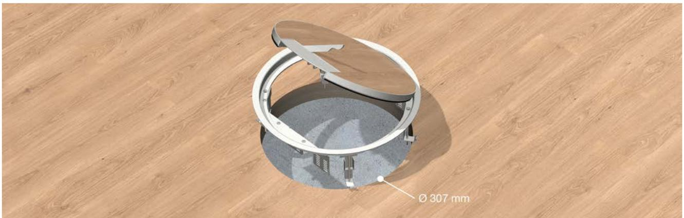
Runde Kassetteneinbaueinheiten mit Bodenbelagsschutzrahmen aus Edelstahl mit einem Außendurchmesser von 330 mm zum Einbau in Hohlraum- oder Doppelböden mit Klemmbereich 40 - 80 mm. Für Bodenbeläge mit einer Stärke von 12 mm geeignet.
